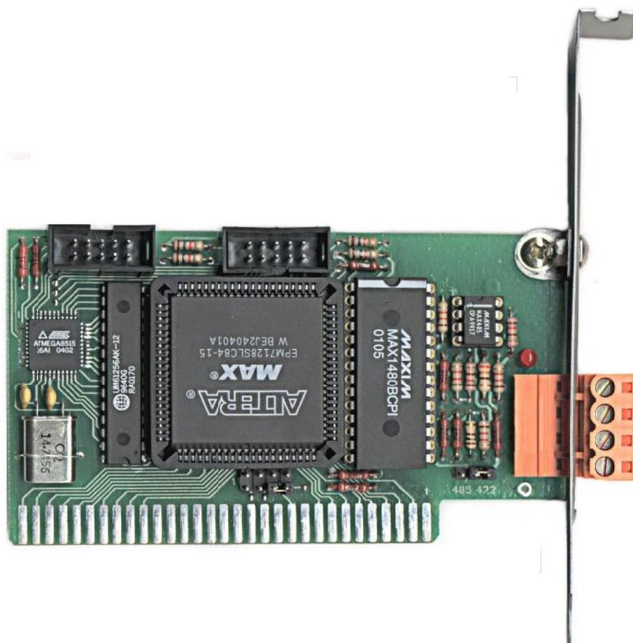
Плата является частью оборудования сети загрузки технологических программ в системы ЧПУ станков, и устанавливается в компьютер-сервер. Плата имеет гальванически развязанный интерфейс RS422/RS485, микроконтроллер ATMega 8515, буферную память, и аппаратную часть, построенную на программируемой логике.
