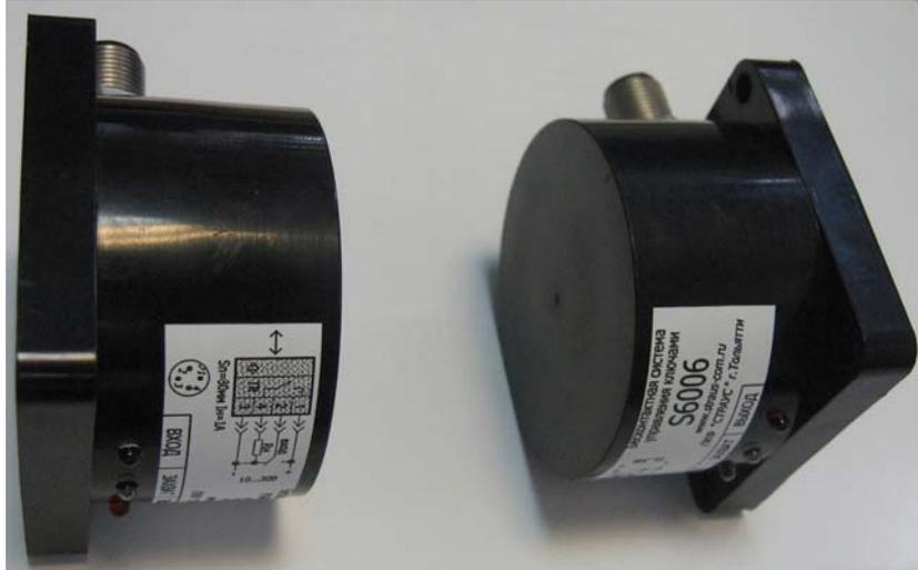
Модули могут находиться на подвижных автономных тележках, на элементах карусели и т.п. В технологическом процессе подвижные объекты с установленными на них модулями поочередно позиционируются напротив неподвижного модуля в зоне “захвата”, что позволяет осуществлять взаимное управление исполнительными устройствами. Количество модулей в подобной системе неограниченно.
